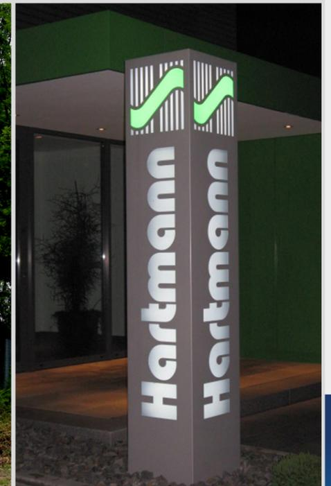
Kombination aus Stahl, Aluminium, Acrylglas und VSG-Glas mit integrierter Mattierungsfolie. Aufgesetzte Buchstaben, 8 mm und 30 mm stark, LED-Ausleuchtung dimmbar.
