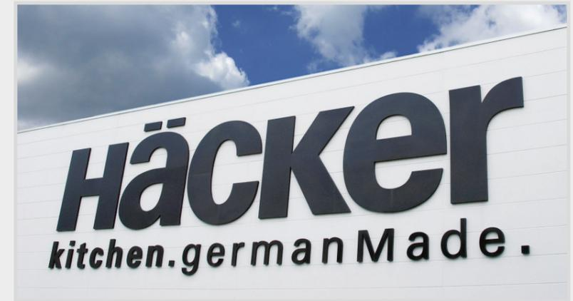
Großformatige Buchstaben, Profil 01 aus Aluminium mit angearbeiteter Zarge, Bautiefe 40 mm, im RAL-Farbtton nach Wahl pulverbeschichtet.
