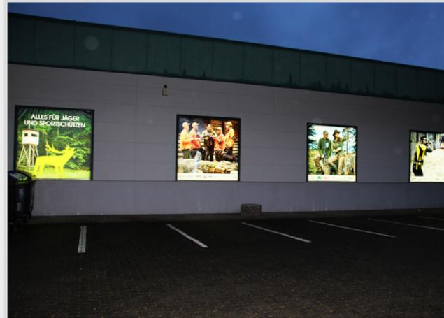
Durch das innovative „Rahmenspiel“ wird eine elegante Werbefläche geschaffen. Bei Bautiefen bis max. 150 mm erreichen wir die optimale Ausleuchtung durch effektive Lichtverteilung, geringe Anzahl von LED-Modulen und somit einen geringstmöglichen Stromverbrauch. Das Motiv kann im Digitaldruck oder als Folienplott auf das transluzente Spanntuch aufgebracht werden. Motivwechsel sind flexibel und kostengünstig zu realisieren.
